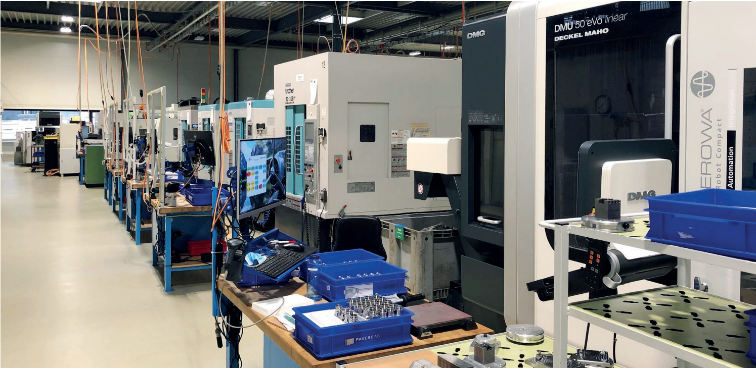
Ausschnitt der digitalisierten Arbeitsplätze im Bereich 3-5 Achsen Fräsen aus der Produktion der Pavese AG
